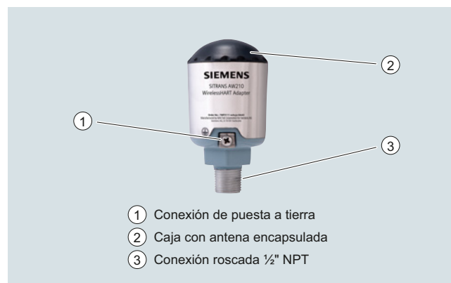
Adaptador Wireless HART SITRANS AW210, estructura
