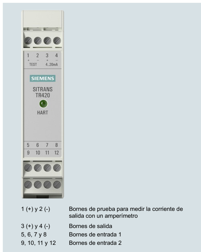
SITRANS TR420, asignación de conexiones
