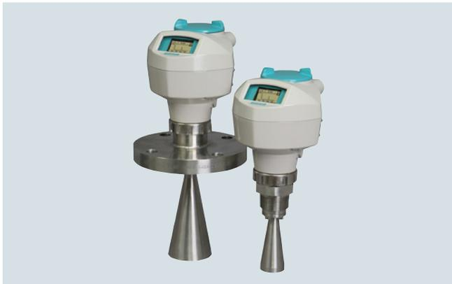
SITRANS LR250 es un transmisor de nivel radar pulsado a 2 hilos, frecuencia 25 GHz, para la medición de nivel continua de líquidos y lodos en depósitos de almacenamiento o recipientes de proceso. Apropiado para rangos de medida hasta 20 m (66 ft) y aplicaciones con presión y temperaturas extremas.
