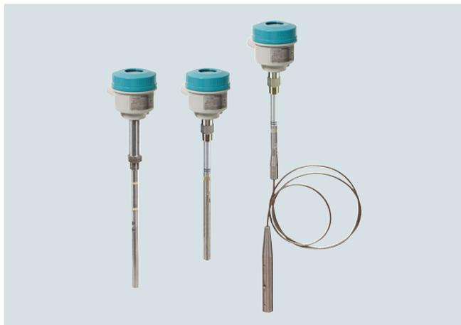
Pointek CLS300 (versión digital) es un detector de nivel capacitivo de frecuencia inversa versátil con sondas opcionales de varilla/cable y salida ajustable. Es ideal para la detección de líquidos, sólidos, lodos, espuma e interfaces en condiciones de presión y temperaturas extremas y tiene la capacidad de ignorar acumulaciones en la sonda. La versión digital ofrece PROFIBUS PA, pantalla LCD y funciones avanzadas de diagnóstico.
