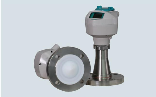
El radar pulsado a 2 hilos SITRANS LR250 con antena encapsulada y brida, frecuencia y frecuencia 25 GHz, mide el nivel de líquidos y lodos de forma continua, en tanques de almacenamiento o de proceso con presión y temperaturas extremas. El rango de medida alcanza los 20 m (66 ft) (depende del tipo de antena).
