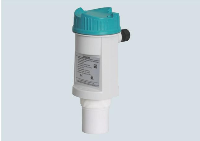
El SITRANS LU180 es un transmisor ultrasónico de nivel compacto y de corto alcance. Este dispositivo intrínsecamente seguro, de 2 hilos alimentado por bucle 4 a 20 mA es ideal para líquidos, lodos y sólidos a granel en depósitos abiertos o cerrados, en rangos hasta 5 m (16.4 ft).
