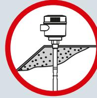
La acumulación de producto o la condensación en la protección active shield no afecta al funcionamiento del detector.
