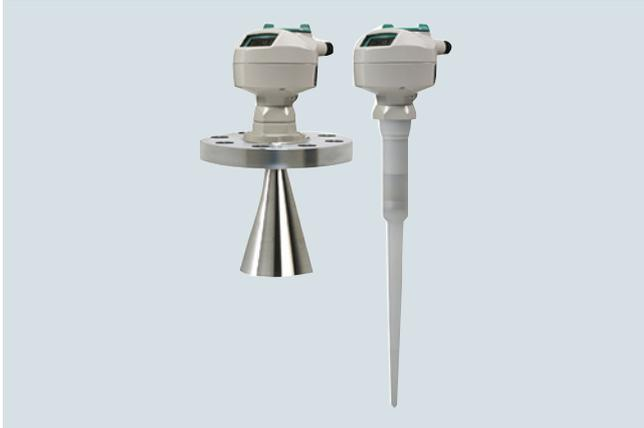
SITRANS LR200 es un transmisor de nivel radar pulsado a 2 hilos, frecuencia 6 GHz, para la medición de nivel continua de líquidos y lodos en depósitos de almacenamiento o recipientes de proceso. Apropriado para rangos de medida hasta 20 m (65 ft) y aplicaciones con agitación, turbulencias, presión y temperaturas extremas.
