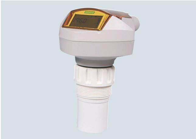
El transmisor ultrasónico de nivel con conexión a 2 hilos SITRANS Probe LU está diseñado para la medición de nivel, volumen y caudal de productos líquidos en canales abiertos y tanques de almacenamiento o de proceso.
