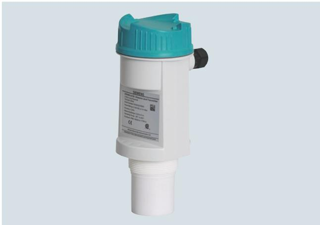
El SITRANS LU150 es un transmisor de nivel ultrasónico de corto alcance. Este transmisor de uso general con conexión a 2 hilos, alimentado por bucle 4 a 20 mA, es ideal para medir productos líquidos, lodos y materiales a granel en tanques abiertos o cerrados y rangos hasta 5 m (16.4 ft).
