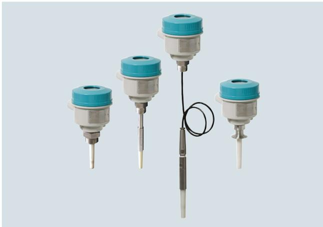
Pointek CLS200 (versión digital) es un detector de nivel capacitivo de frecuencia inversa versátil con sondas opcionales de varilla/cable y salida ajustable. CLS200 es ideal para la detección de líquidos, sólidos, lodos, espuma e interfaces y tiene la capacidad de ignorar acumulaciones en la sonda. La versión digital ofrece PROFIBUS PA, pantalla LCD y funciones avanzadas de diagnóstico.
