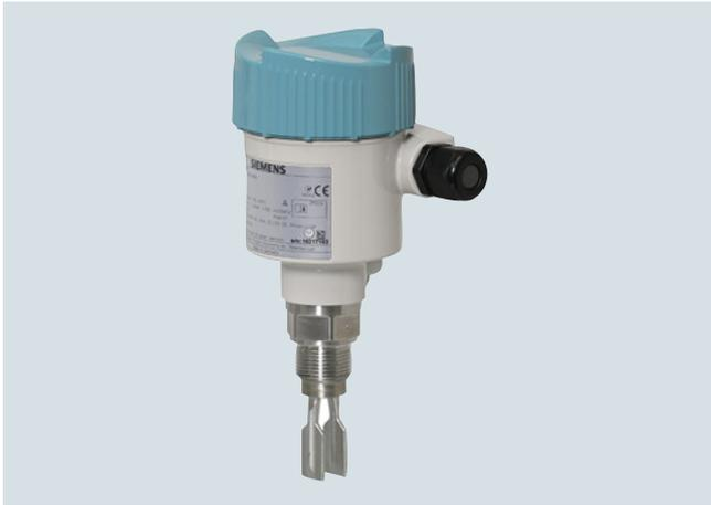
SITRANS LVL200 es un interruptor de nivel vibratorio estándar para detección de materiales en aplicaciones con líquidos y lodos. Aplicaciones típicas: protección contra sobrellenado, detección de nivel máximo/mínimo o ajuste específico, protección de bombas. Certificado para su uso en aplicaciones SIL-2.
