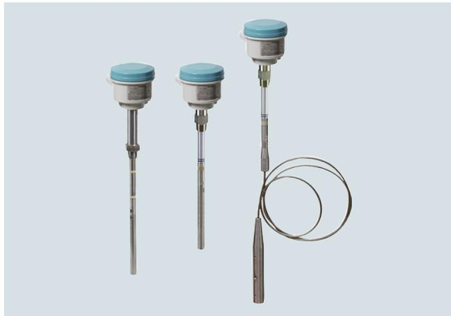
Pointek CLS300 (versión estándar) es un detector de nivel capacitivo de frecuencia inversa versátil con sondas opcionales de varilla/cable y salida ajustable. Es ideal para la detección de líquidos, sólidos, lodos, espuma e interfaces en condiciones de presión y temperaturas extremas y tiene la capacidad de ignorar acumulaciones en la sonda.
