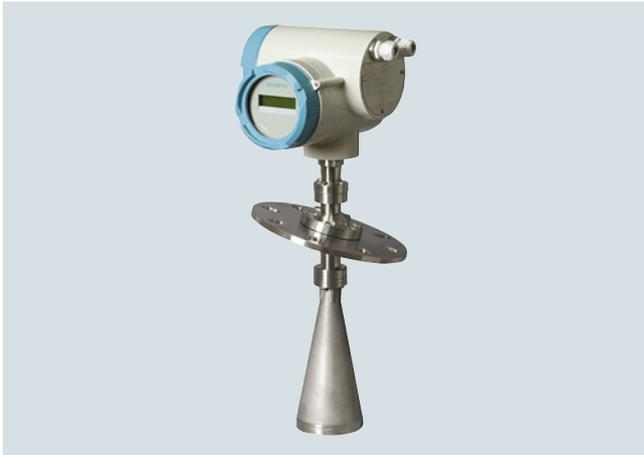
El SITRANS LR460 es un transmisor de nivel por radar FMCW de 24 GHz, a 4 hilos, con relación señal-ruido extremadamente alta y procesamiento de señal avanzado para la vigilancia continua de sólidos hasta a 100 m (328 ft). Es muy apropiado en entornos con condiciones extremas de polvo y temperatura.
