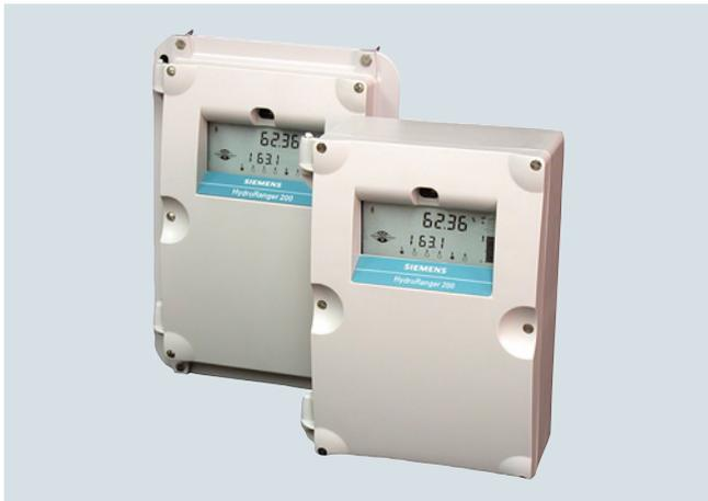
El transmisor de nivel por ultrasonidos HydroRanger 200 controla hasta seis bombas. Monitoriza el nivel, el nivel diferencial y el caudal en canal abierto.
