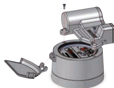
Fig. 5 : installazione del modulo EDC-S su un contatore con orologeria in rame (IP68)
