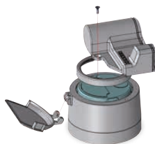
Image 4: Montage de l'EDC-C
