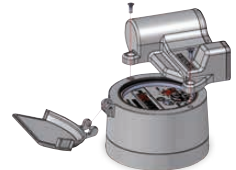
Abb. 5: Montage des EDC-S auf Zähler mit Kupfer/Glas-Zählwerk (IP68)
